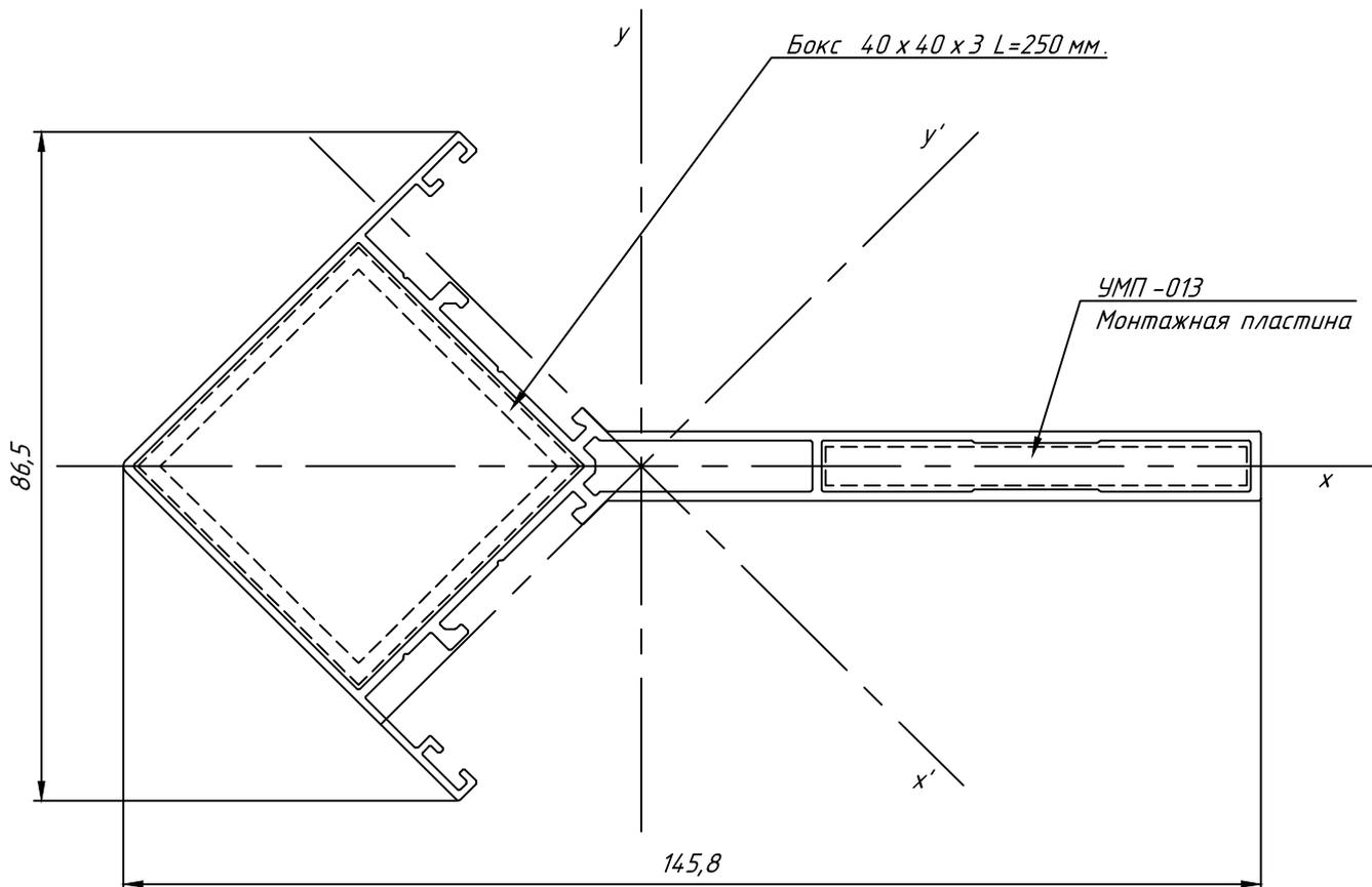
Соединение стоек по длине предусмотрено с использованием монтажной пластины УМП-013 и бокса 40x40x3 мм. L=250мм. Крепление к перекрытиям предусмотрено с использованием кронштейнов УМП-048 и опор УМП-077, УМП-077-01.
